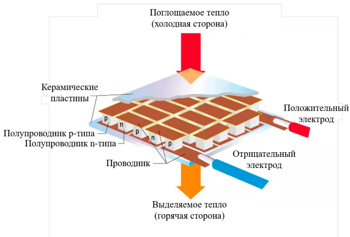
Рис. 1. Внутреннее устройство элемента Пельтье.
