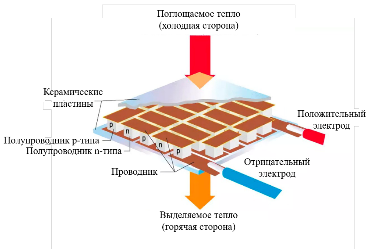
Рис. 1. Внутреннее устройство элемента Пельтье.
