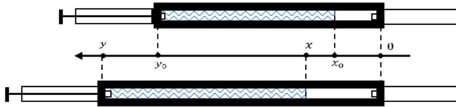
Рис. 3. Установка для измерения коэффициента Пуассона материала трубки
